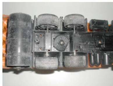
Système arbre et roues assemblées en force. L'arbre est guidé par une forme cylindrique moulée dans le châssis. Facile à comprendre, difficile à réaliser.
