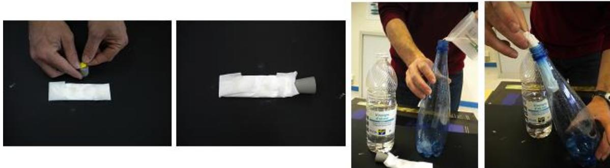
Pour lancer la fusée, il faut retourner la bouteille fermée dans le verre et attendre que la pression à l'intérieur de la bouteille soit suffisante pour expulser le bouchon, le vinaigre, le gaz, et propulser ainsi la bouteille (explication sur l'expérience dans l'annexe 1).
