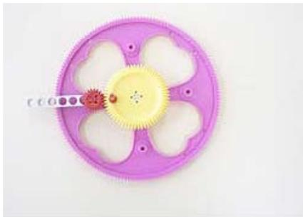
La maquette permet de transmettre un mouvement, mais sans accélération car la roue motrice est sur le même arbre que la roue représentant le haut du panier à salade. La roue rouge ne sert à rien.
