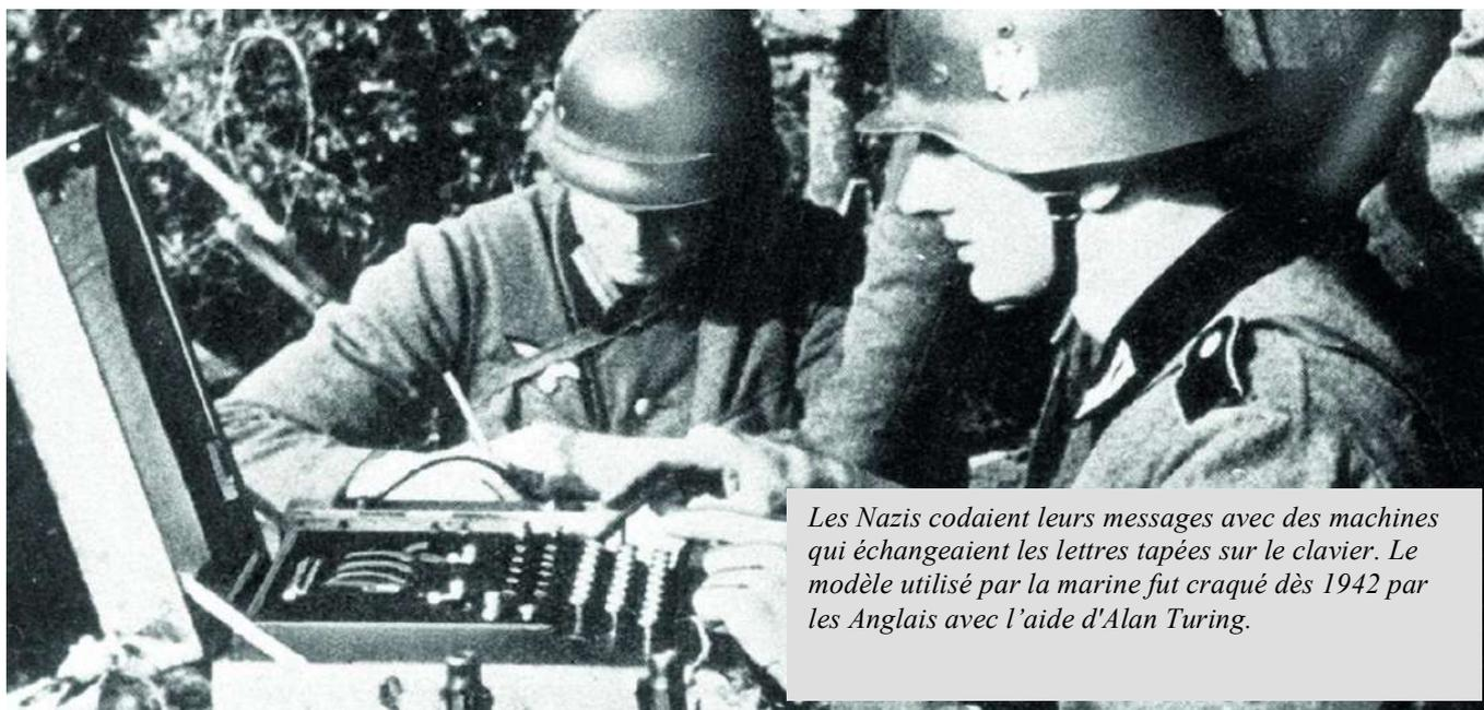
*Les Nazis codaient leurs messages avec des machines qui échangeaient les lettres tapées sur le clavier. Le modèle utilisé par la marine fut craqué dès 1942 par les Anglais avec l'aide d'Alan Turing.*
